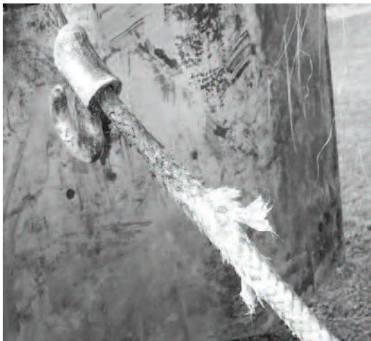
Usure au niveau de l'épissure liée au passage répété du crochet
